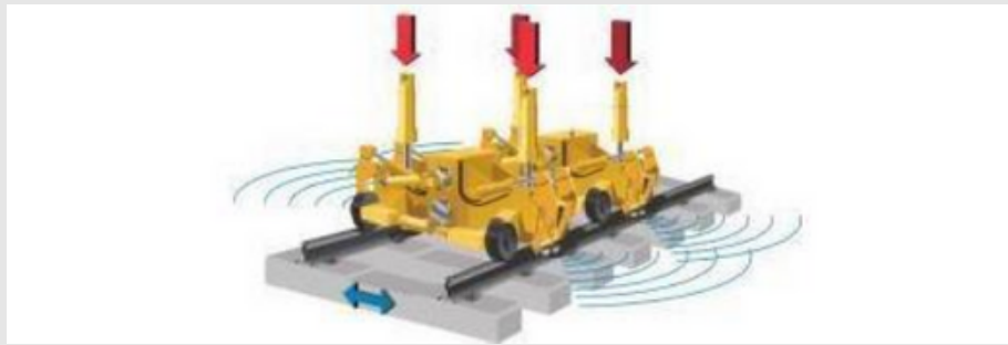
Figura 07: Princípio de estabilização da Via com o DGS. Fonte: Pereira et al 2021
