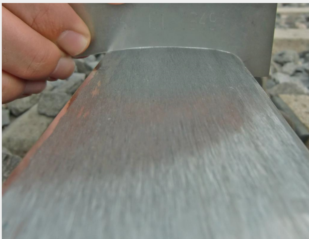
Fig. 2: Superfície do trilho com um acabamento perfeito através da tecnologia de fresamento de alto desempenho da Linsinger
