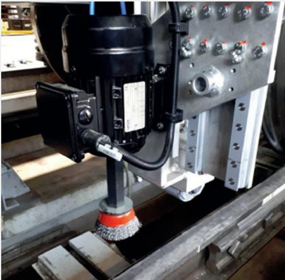
Fig. 1c: Escova giratória para limpeza posterior da superfície do trilho
