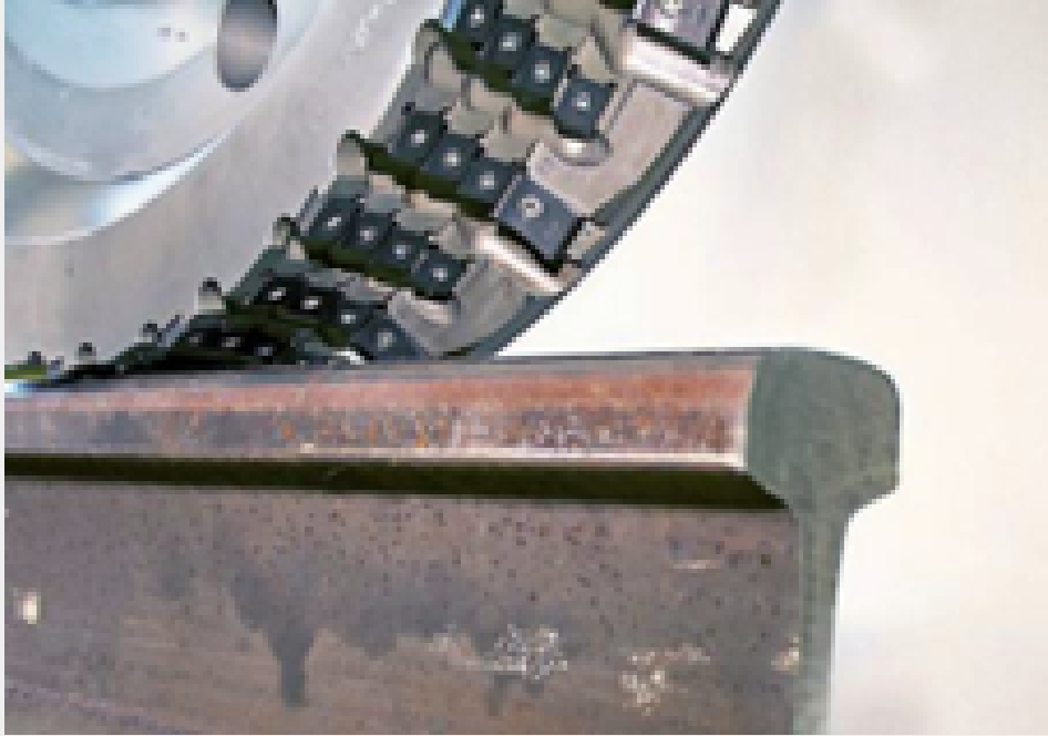
Fig. 1a: Roda de fresagem de circular para refazer o perfil dos trilhos e remover completamente os danos
