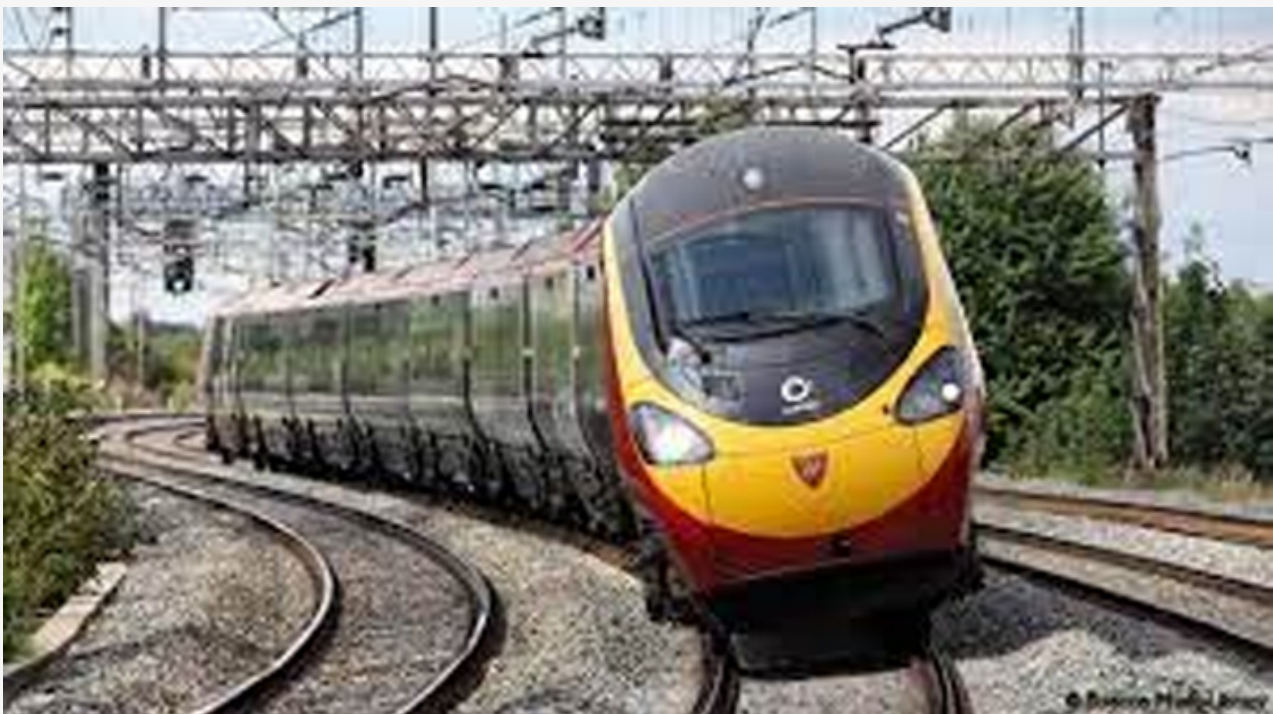
Figura 11 – Trem pendular de inclinação ativa em curva.
